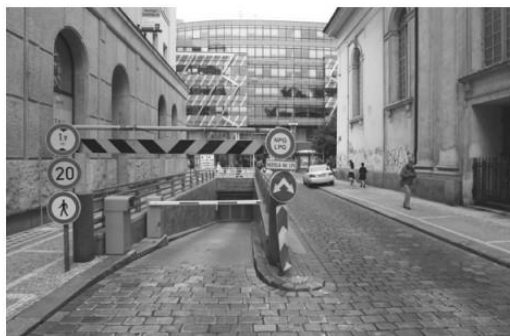
[OBR 31 ] Ukázka garážové rampy s chodníkovým přejezdem (vlevo) a rampy umístěné ve veřejném prostoru (vpravo) přerušující kontinuitu prostoru pro pěší
